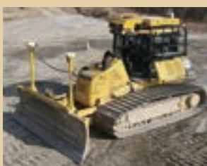
当社は2013年より遠隔操作や自動・自律で運転する建設機械「T-iROBOシリーズ」の開発を進めており、土砂山を検出し押土経路を自ら決定する自律制御型ブルドーザーを開発・適用を実現しました。
